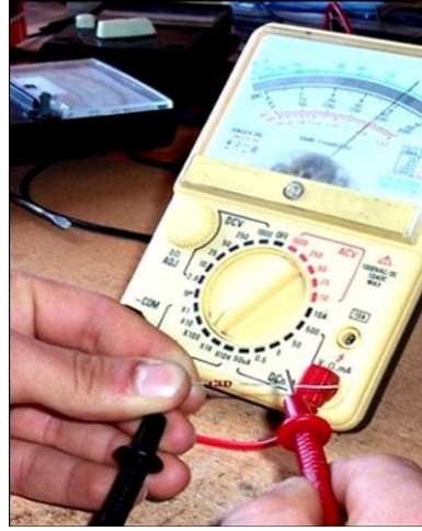
Resim 1.5: Avometre ile direnç ölçümü
